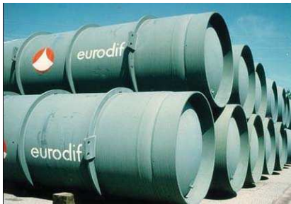
Emballages de transport d'hexafluorure d'uranium.
